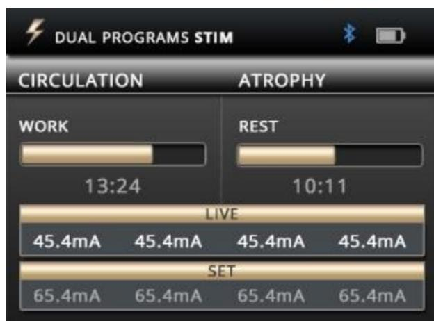
Im Dual-Programm-Modus werden zwei Programme nebeneinander angezeigt. Die Kanäle sind paarweise gruppiert, Kanal A und B für das Programm auf der linken Seite und C und D für das Programm auf der rechten Seite.
