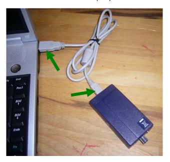
Nun stecken Sie das eine Ende des Glasfaserkabels in den TT-USB-Adapter und das andere in den ProComp Infiniti (oder das alternativ von Ihnen verwendete Biofeedbacksystem).
