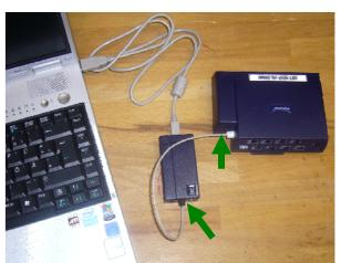
3. Achten Sie darauf, dass die Anschlüsse richtig angeschlossen werden. Der Regelfall für die Anschlussbelegung am ProComp Infiniti ist Folgender: **G=RED**; **H=I-RED**
