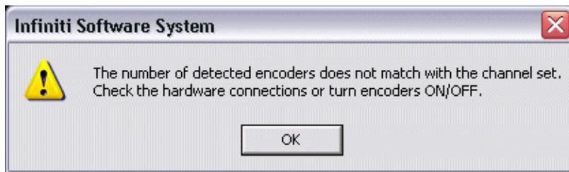
Hier müssen sie entweder die Einstellung der DIP-Schalter am Encoder (Unterseite) ändern oder eine andere Kanaleinstellung wählen. Weitere Information finden sie im Kapitel *Einstellungen DIP-Schalter*.
